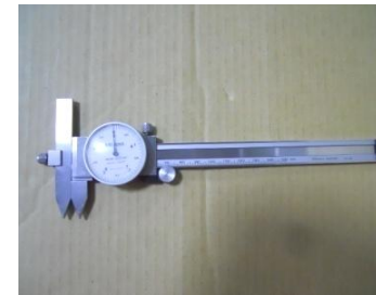
MITUTOYO 度盤式卡尺
